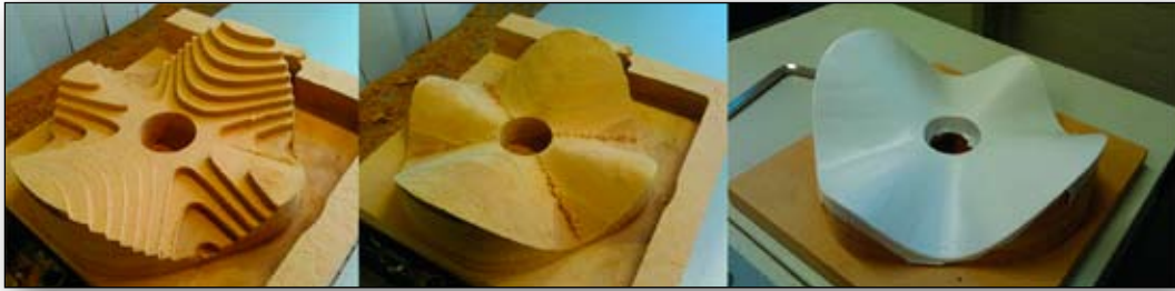
Afbeelding 9. Vacuumvorm-mal: podium voor groot evenement Rietveld Adacemie, Frank van 't Woudt).
