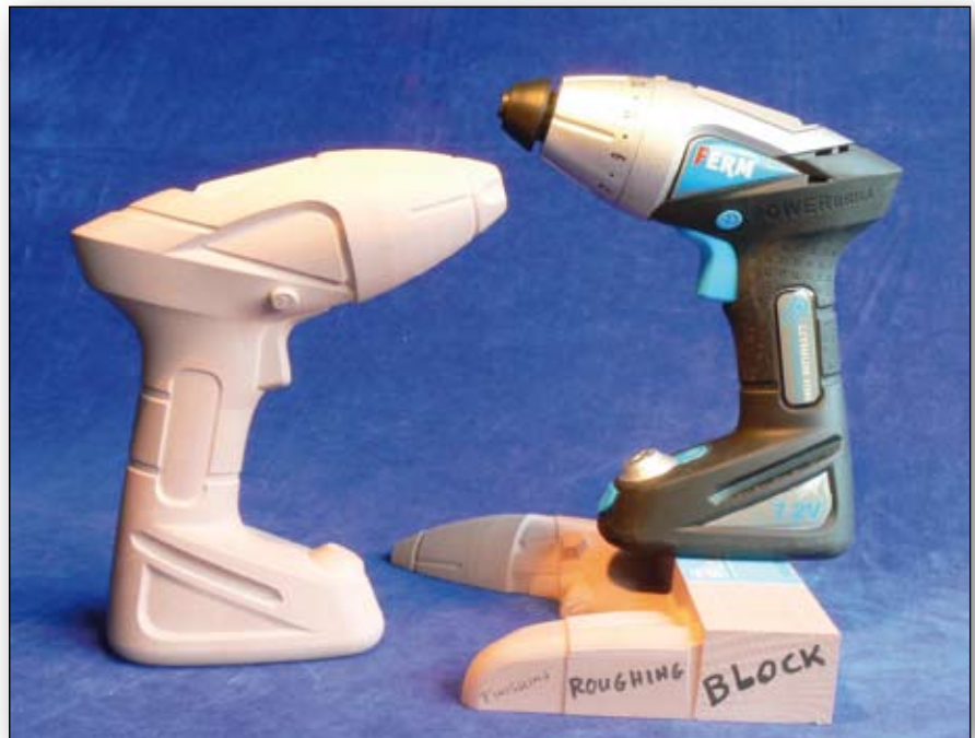
Afbeelding 6. Het gefreesde model en definitieve product (Ferm).
