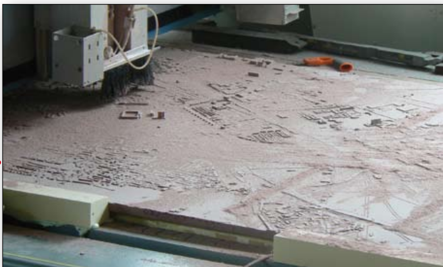
Afbeelding 7. De maquette van Maastricht wordt gefreesd.
