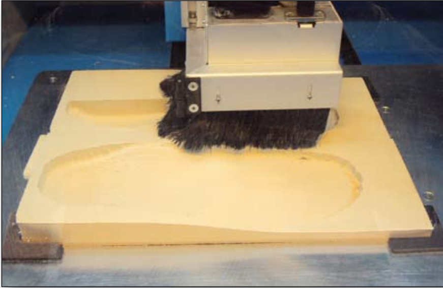
Afbeelding 4. Frezen van inlegzolen in schuim (Podo Cad Cam Design door Oosterhof).
