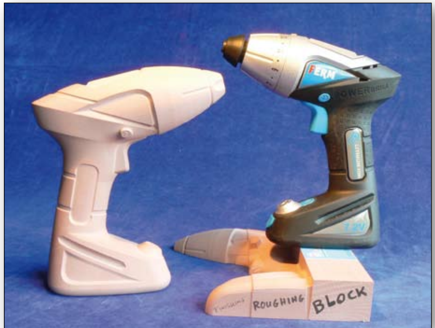
Afbeelding 6. Het gefreesde model en definitieve product (Ferm).
